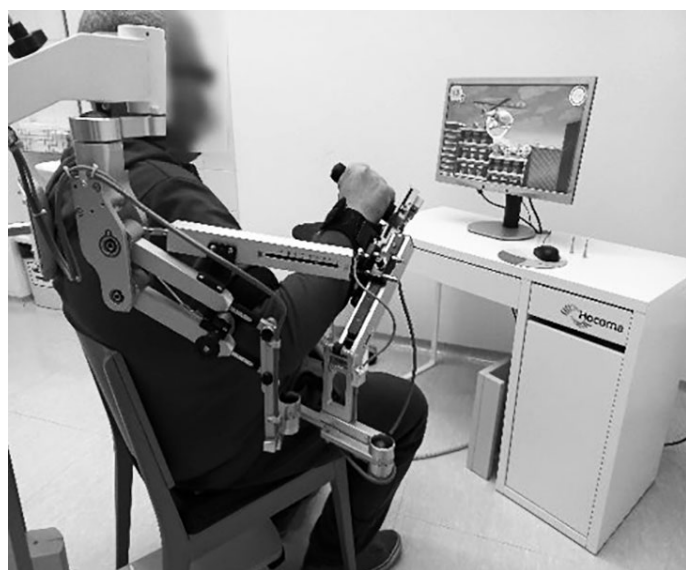
Slika 1: Uporabnik med robotsko terapijo na napravi Armeo® Spring.
