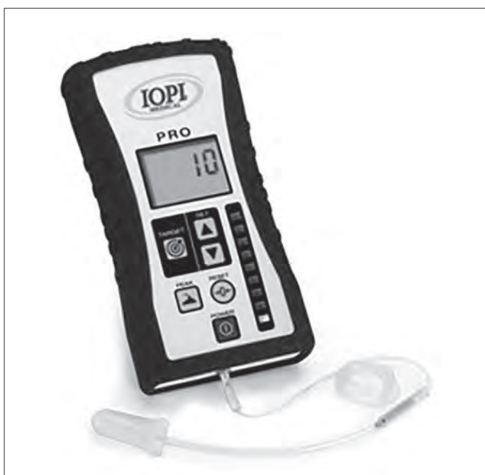
Slika 2: IOPI Pro model s plastičnim konektorjem in zračno blazinico (1). Picture 2: IOPI Pro model with plastic tubing and air-filled bulb (1).
