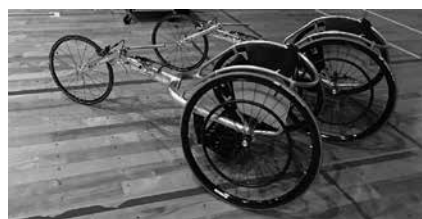
Slika 2: Športni voziček, namenjen atletskim disciplinam in paratriatlonu (osebni arhiv).
