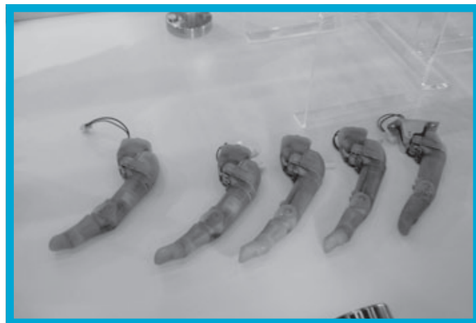
Slika 15: Mioelektrična proteza za prst ProDigits.
