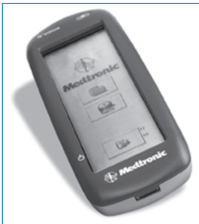
Slika 3: Programator N'Vision, s katerim telemetrično usmerjamo delovanje vsajene baklofenske črpalke
