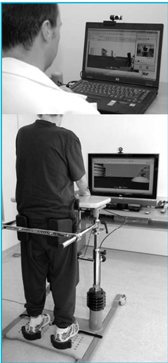
Slika 1: Sistem za telerehabilitacijo. Zgornja fotografija prikazuje fizioterapevta, ki spremlja preiskovanca in njegovo izvajanje naloge v spletnem brskalniku preko videokonference ter mu daje ustrezne napotke. Spodaj preiskovanec izvaja vadbo ravnotežja z nalogo v navideznem okolju.
