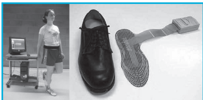
Slika 1: Sistem F-Scan za meritev stopalnih pritiskov.
