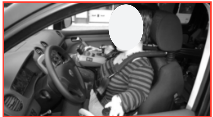
Slika 2: Elektronski sistem – ročica za upravljanje volana, zavore in plina; pomik nazaj – plin, pomik naprej – zavora, pomik levo in desno – obračanje volana).
