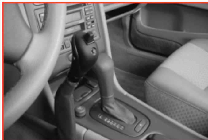
Slika 1: Mehanske naprave – ročica (desno ob volanu) za ročno upravljanje zavore in plina pri avtomobilu z avtomatskim menjalnikom.
