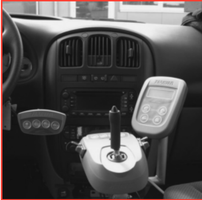
Slika 2: Elektronski sistem – ročica za upravljanje volana, zavore in plina; pomik nazaj – plin, pomik naprej – zavora, pomik levo in desno – obračanje volana).
