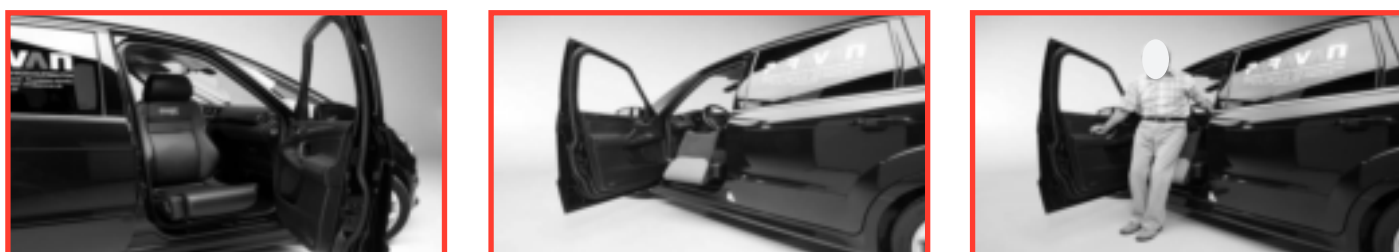
Slika 3: Vrtljiv in dvižni sedež, ki omogoča lažje vstopanje v avto in izstopanje iz njega.
