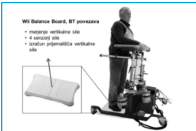
Slika 1: Naprava za zajemanje posturalnih odzivov temelji na generiranju mehanske motnje (perturbacije) v višini bokov v osmih smereh transverzalne ravnine. Odmik projekcije težišča izmerimo s pritiskovno ploščo (Nintendo Wii Balance Board). Pritiskovna plošča je z merilnim sistemom povezana prek bluetooth (BT).
