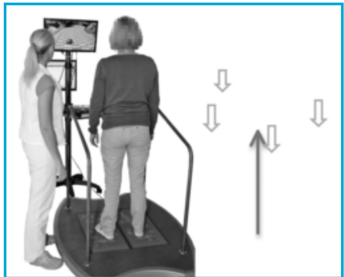
Slika 3: Naprava Gamma sestavlja 2 pritiskovni plošči, ki spremljata potek vertikalne komponente sile ob prenosu teže in informacijo ustrezno posredujejo v obliki premikanja objekta v navideznem okolju.
