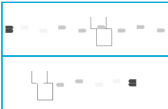
Slika 2: Projekcijsko okno: začetek hoje z levo nogo in obrisi vseh stopal (zgoraj) in začetek hoje z levo nogo in s prikritimi obrisi stopal čez pritiskovni plošči.
