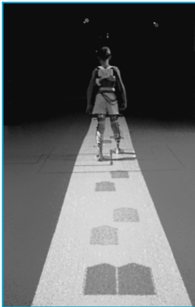
Slika 3: Steza za usmerjanje hoje pri merjenju kinematike in kinetike hoje otroka; rdeče v ozadju kamera Vicon MX.
