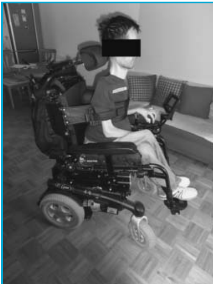
Slika 2: Voziček na elektromotorni pogon za ljudi, ki se zelo težko gibljejo, z individualno izdelano sedežno enoto in dodatki.
