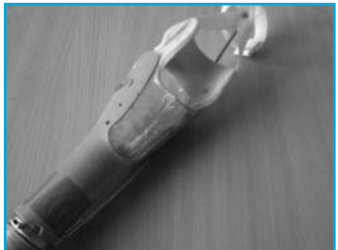
Slika 5: Testna ali začasna transradialna funkcionalno-mehanska proteza, izdelana po sedaj uveljavljenem postopku izdelave.
