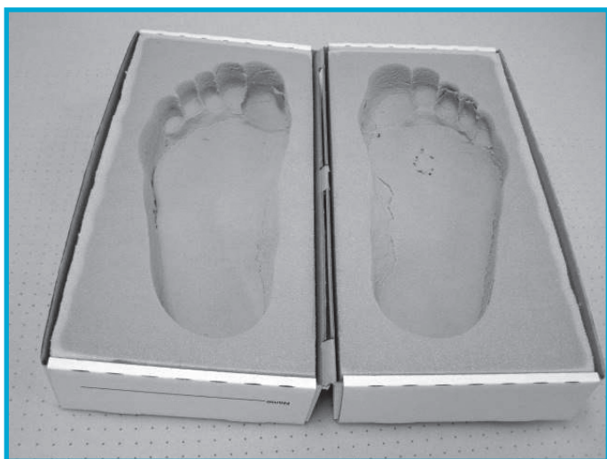
Slika 1: Odvzem odtisa stopal s peno iz pedilena – statična meritev.
